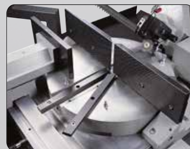
Plateau tournant sur roulement à billes
