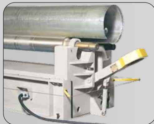
Ouverture hydraulique du palier
