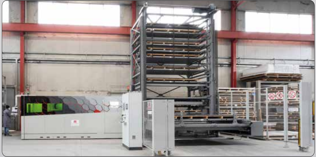
Tour de stockage avec système de chargement et déchargement automatique
