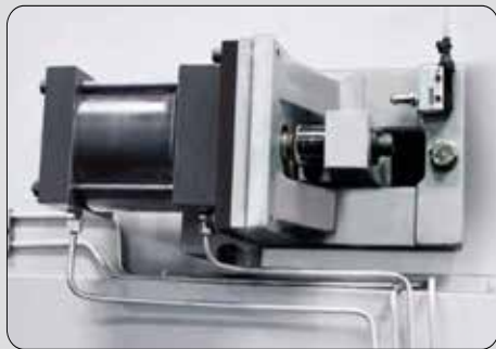
Tension hydraulique et automatique de la lame
