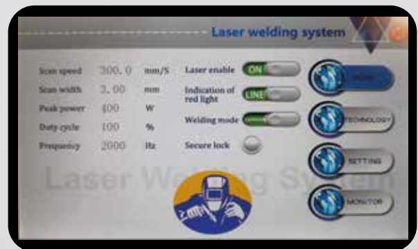
Réglage des paramètres de soudure et sauvegarde dans base de données
